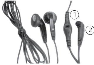
Figura 16: accesorio/conector del sistema FM (1) y conector del procesador (2) a los auriculares de monitorización
