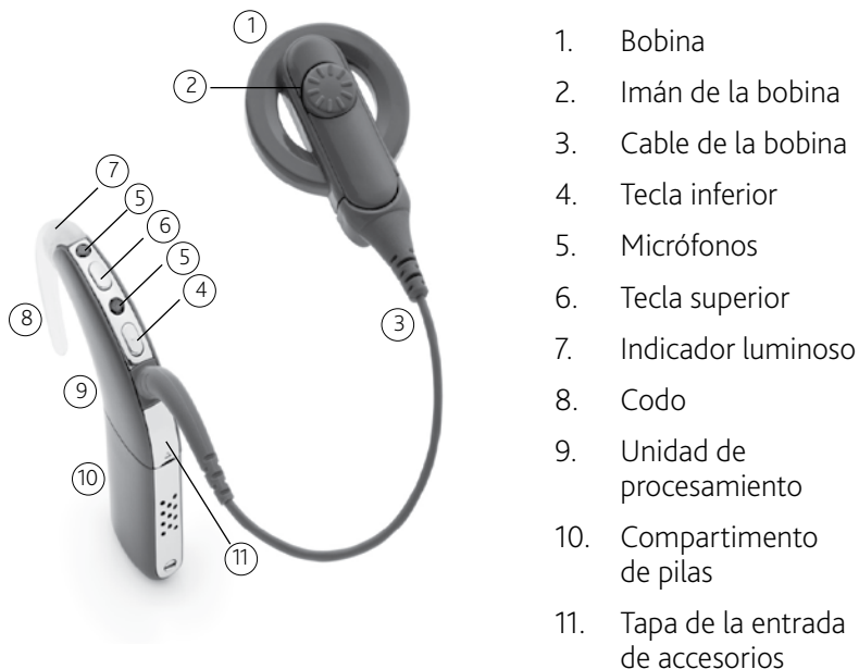
Figura 1: partes del procesador de sonido CP810
